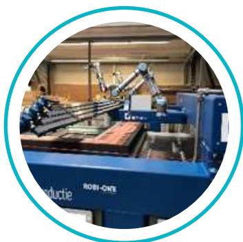
Les relevés de l'existant et la **maquette numérique** réalisée permettent la préfabrication des modules hors site. Ceux-ci peuvent être élaborés par des **machines à commande numérique**, qui utilisent le modèle créé précédemment (CAO : conception assistée par ordinateur, puis FAO : fabrication assistée par ordinateur).
